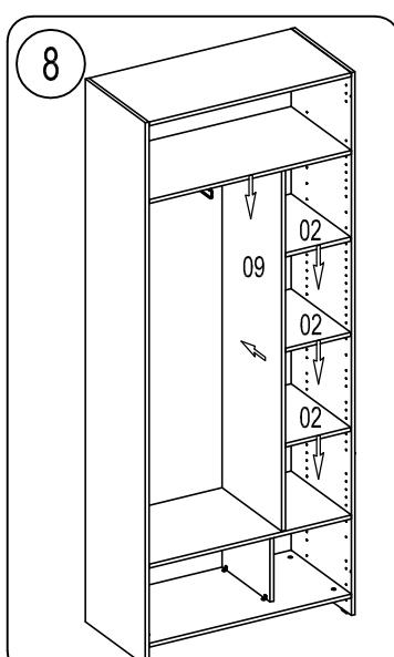
Снизу, под вертикальной стенкой, установить опору
